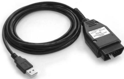
ДК-5 предназначен для проведения диагностики электронных систем управления дизельных двигателей. Прибор выполнен в виде соединительного кабеля, оснащенного разъемами для подключения устройства к колодке диагностической автомобиля (стандарта OBD-II) и к USB-порту компьютера (Type A).
